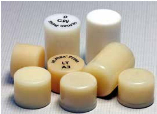
Abb. 10.14 Keramikpellets für die Presstechnik
