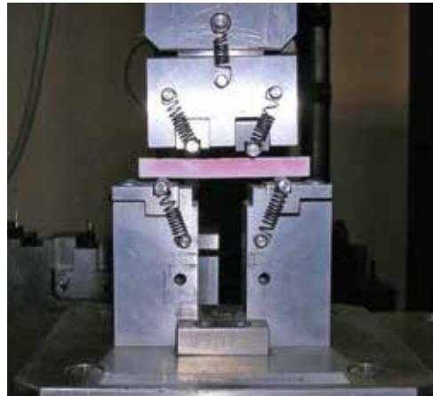
Abb. 10.3 So sieht der 4-Punkt-Biegeversuch in der Praxis aus (Foto: WZR ceramic solutions GmbH)
