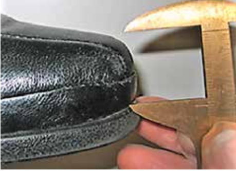
Abb. 2.13 Schuhhöhenmessung abzüglich Stärke von Obermaterial und eventuellen Einlagen
