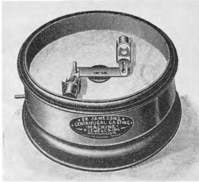
Abb. 13 Schleudergußapparat nach Jameson 1907 mit Spiralfederantrieb und Schutzschirm (n. Scheff). Erschmelzen des Gußgutes in einem der Gußmuffel vorgelagerten Tiegel, Bunsenbrenner in der Bodenplatte integriert
